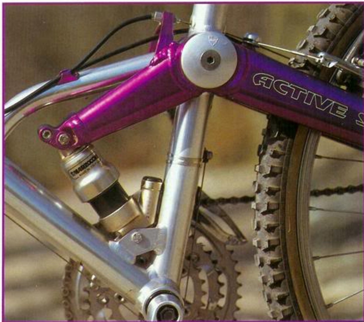
Draaipunt in de zitbuis, monoshock Marzocchi demper, kabel dóór zitbuis.
